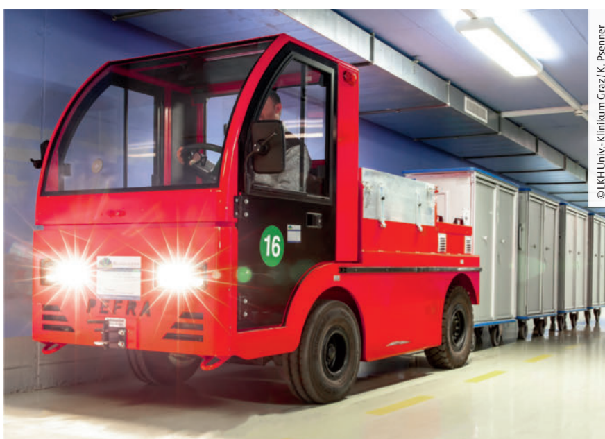
Zustellung über den Logistiktunnel mit E-Schleppern
